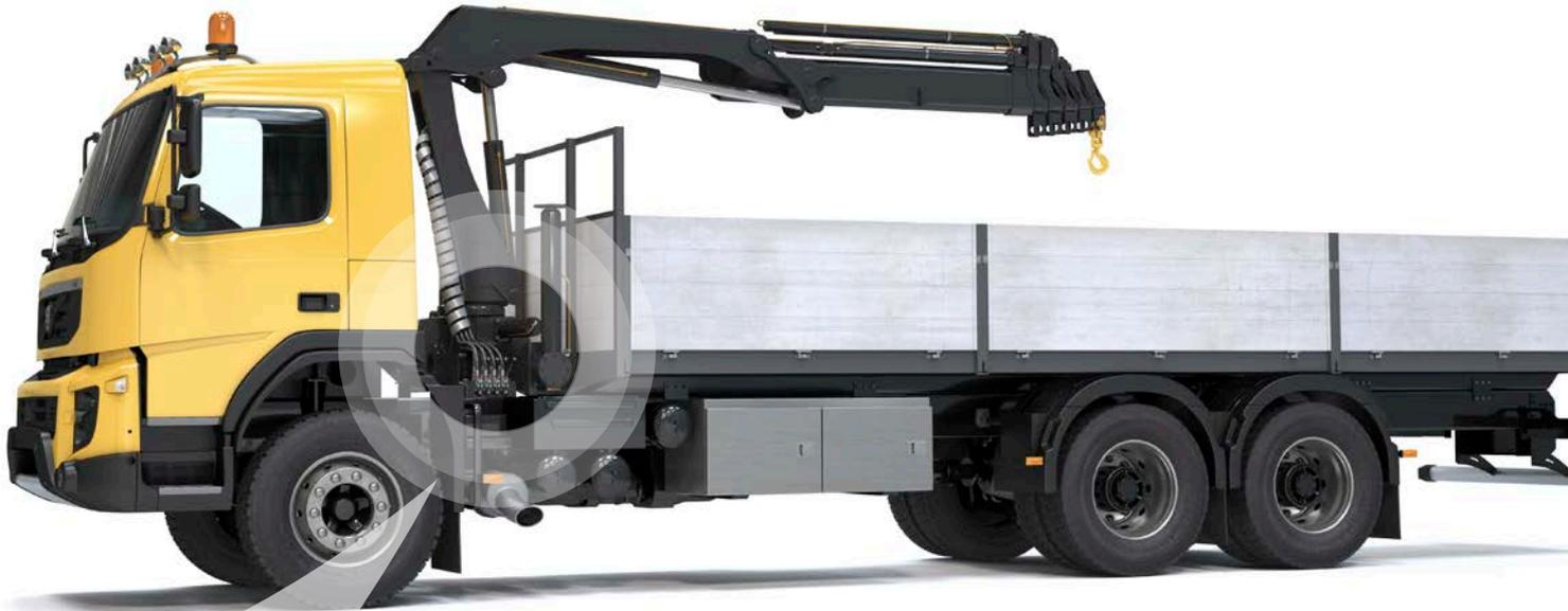
**PARA APLICAÇÕES COM TOTAL ROTAÇÃO DA MANGUEIRA**, a solução ideal é o WEO giratório. O guindaste de um caminhão com mangueiras montadas no bloco valvulado, giram e torcem, causando desgaste do sistema. Utilizando o WEO giratório, as mangueiras se movimentam livremente, com rotação de 360 graus e total pressão de trabalho.
