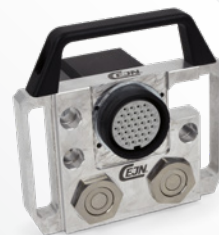
PLAQUE AUTO DOCK pour l'essai à froid d'un moteur de voiture, deux conduites de carburant et un contact électrique pour les signaux
